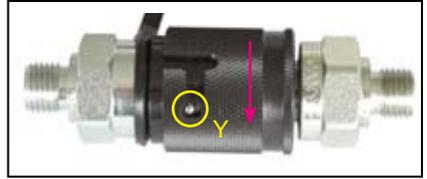
Avant le couplage, retirer les capots anti-poussière puis tirer et maintenir la douille de verrouillage du manchon (position X). Brancher le raccord mâle et le manchon ensemble et relâcher la douille de verrouillage. Tourner ensuite la douille de verrouillage en position Y. La liaison est maintenant établie et bloquée. Le découplage se fait dans l'ordre inverse.
