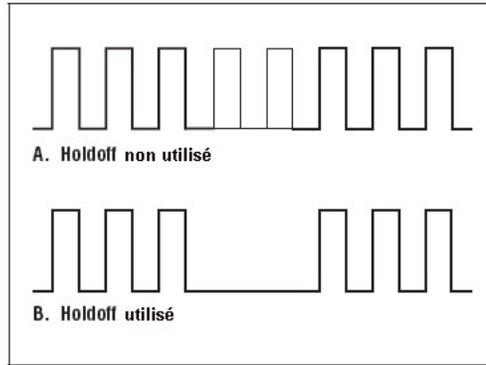
**Figure 3. Utilisation du contrôle HOLD OFF.**
