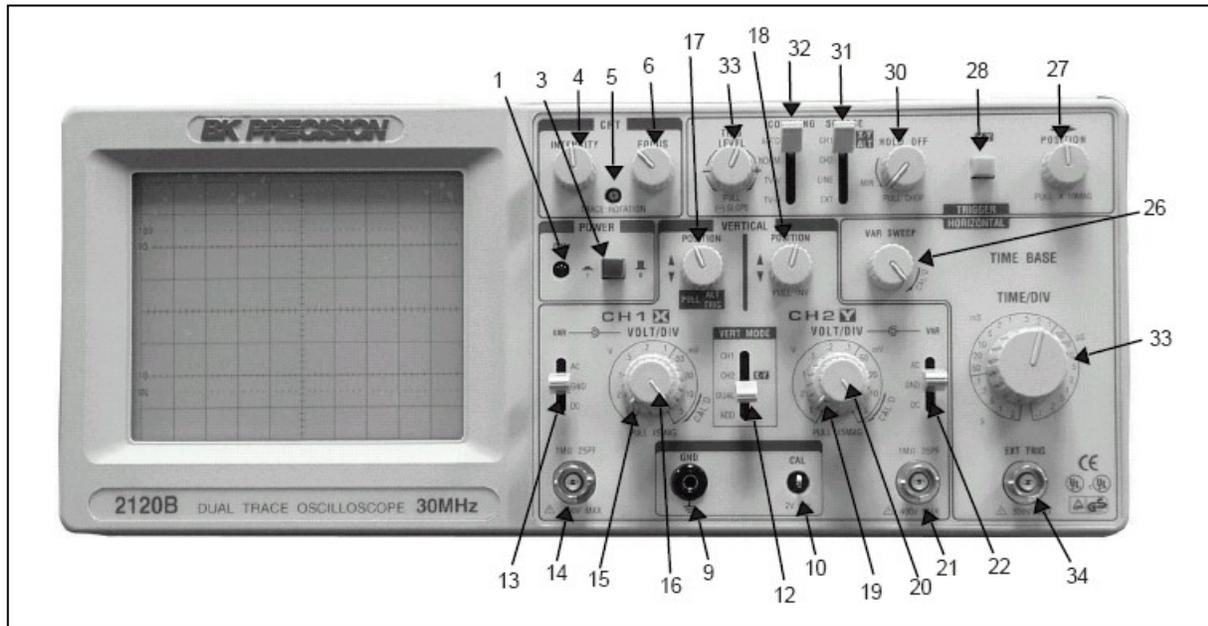
15. Réglage de la sensibilité CH1. Ce commutateur rotatif permet de régler la sensibilité de la voie 1 de 5mV/div à 5V/div en séquences 1-2-5, lorsque le mode X-Y est choisi ce commutateur règle la sensibilité de l'axe X.
