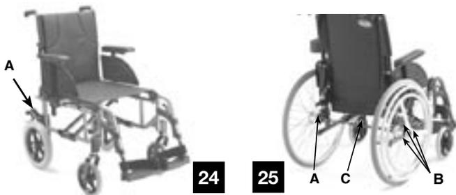
**⚠ Remontez la roue en vérifiant bien que le bouton (A) est bien enclenché, risque de chutes ou de blessures graves si la roue n'est pas bien verrouillée dans son logement !**
