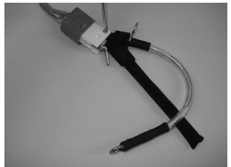
6 / Replacer le boot de harnais de le mécanisme et remettre la vis.
