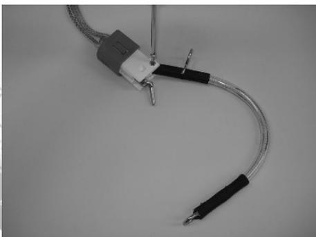
5 / Replacer le boot de harnais de le mécanisme et remettre la vis.
