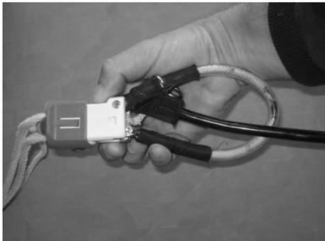
3 / Pour ré-assembler le mécanisme, introduisez l'anneau du boot de harnais dans le crochet largueur, remonter le crochet à l'intérieur du mécanisme, soyez sûr que l'anneau est bien positionné verticalement entre les deux pièces plastiques blanches et que le crochet est parfaitement rentré dans l'encoche.
