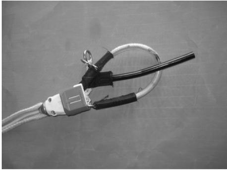
1/ Lorsque le largueur BRAIN est fermé, les deux positionneurs du collier rouge sont rentrés dans les encoches. Le collier rouge de larguage est tiré au maximum vers le bas. Le mécanisme est actif.
