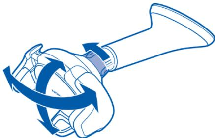
**Conseil :** Le support ne pivote pas facilement ? Pour desserrer l'écrou de serrage, faites-le pivoter vers la droite.
