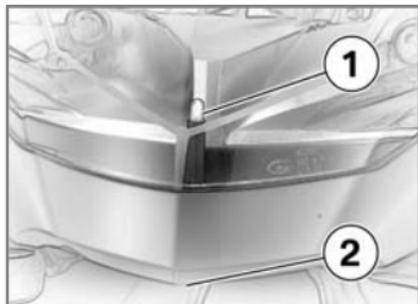
L'ampoule du feu de position **1** est accessible par **2**.
