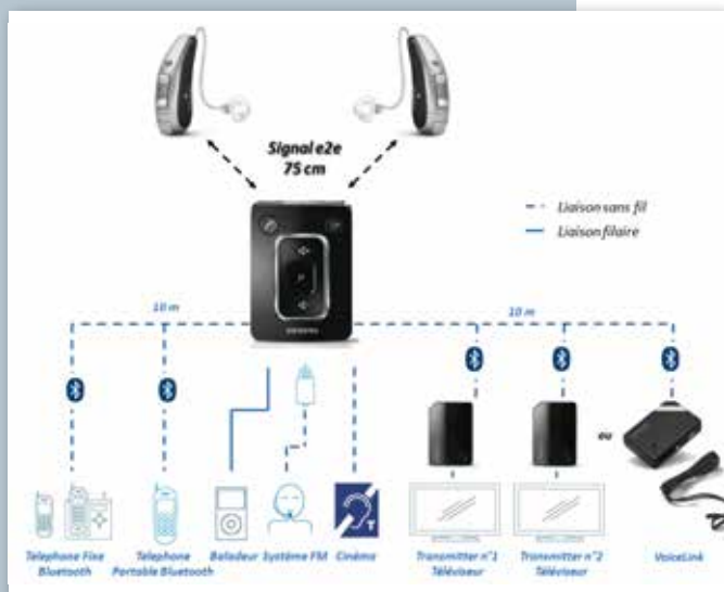
Figure 8 : différentes connexions possibles avec une miniTek.
