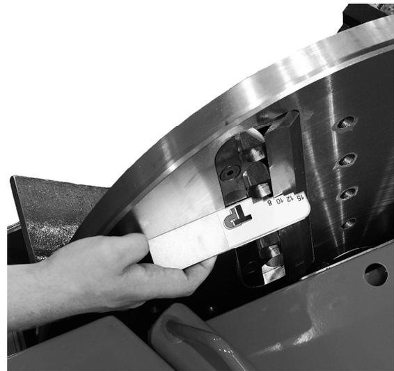
Figur 16 Calibre à lames
