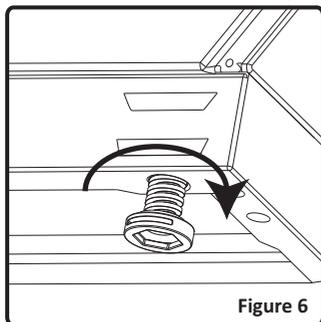
Votre cuisinière possède 4 pieds réglables. Après l'avoir positionné à la place prévue, il est nécessaire de vérifier la mise à niveau. Pour cela, ajustez les 4 pieds réglables en les vissant ou dévissant (fig. 6). **La cuisinière doit absolument être positionnée à l'horizontale.**
