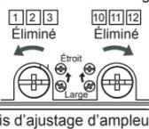
**NOTE** En réglant l'ampleur de la zone de détection, assurez-vous de visser les vis d'ajustage jusqu'à ce qu'elles fassent clic. [1][2][3] ne peuvent pas être éliminés séparément, ni [10][11][12].
