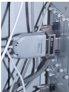
Figure 7 Connexion de l'interface USB-GPIB
