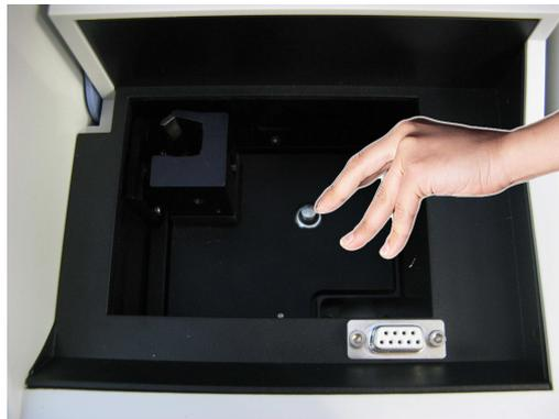
.Fig. 7 Comment installer le puits de cuve
