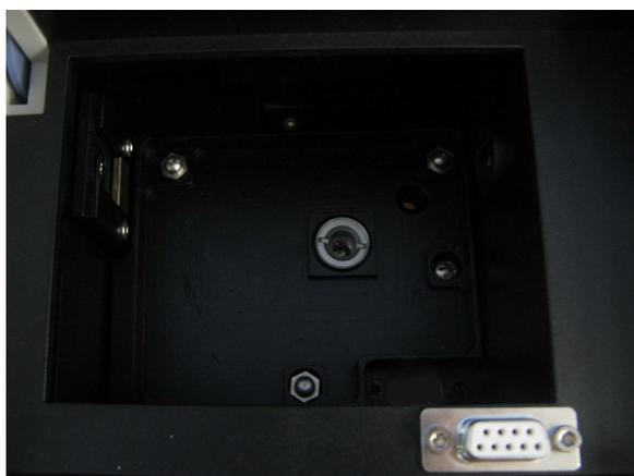
.Fig. 5 Puit de cuve sans le support cuve
