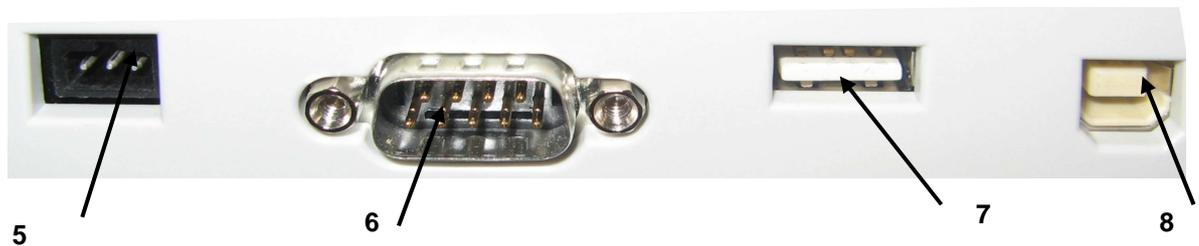
.Fig. 2 Arrière de l'appareil avec les connexions
