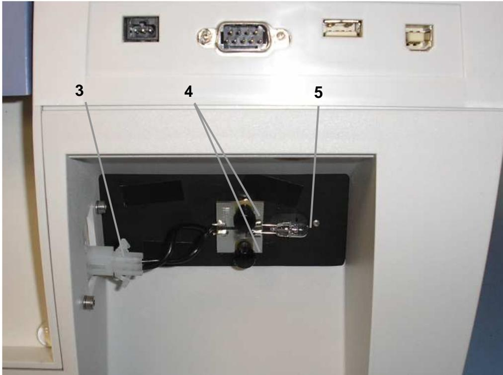
.Fig. 12 Changement de la lampe halogène
