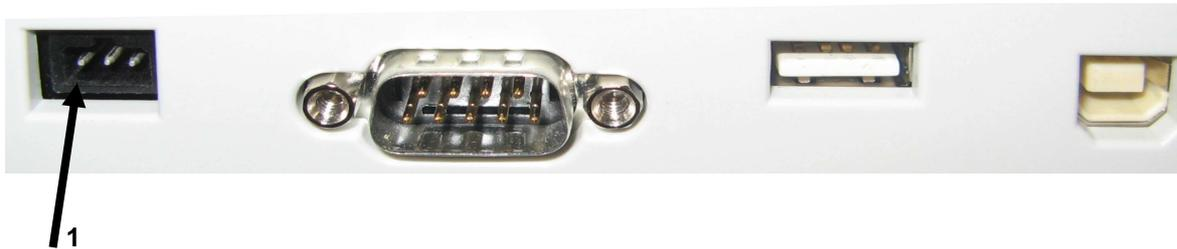
*.Fig. 10 Raccordement du transformateur d'alimentation*
