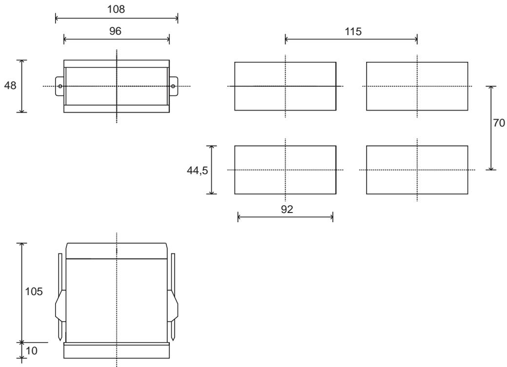
Face avant: 96x48mm (1/8DIN). Profondeur 105mm
