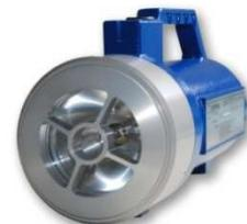
Utiliser la LT15 à une distance de 3-5m dans l'axe du détecteur à tester et l'actionner grâce au bouton poussoir « MARCHE ». Il est nécessaire de passer en mode « LT15 » par l'intermédiaire de la TLU.
