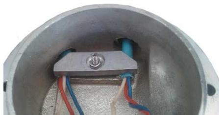
La tresse de masse est enroulée autour de la gaine. Le pontet mécanique la maintient en position et réalise le contact électrique.
