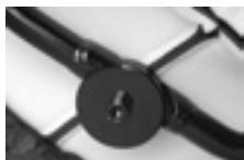
Met een inbussleutel maat 8 kan het tandsscharnier worden los- en vastgedraaid.
