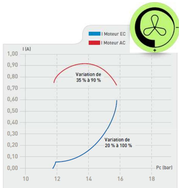
Différence de consommation électrique entre un ventilateur électronique (courbe bleu) et un ventilateur traditionnel (courbe rouge).
