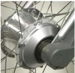
Moteur intégré dans le moyeu avant : 250W d'aide au pédalage.
