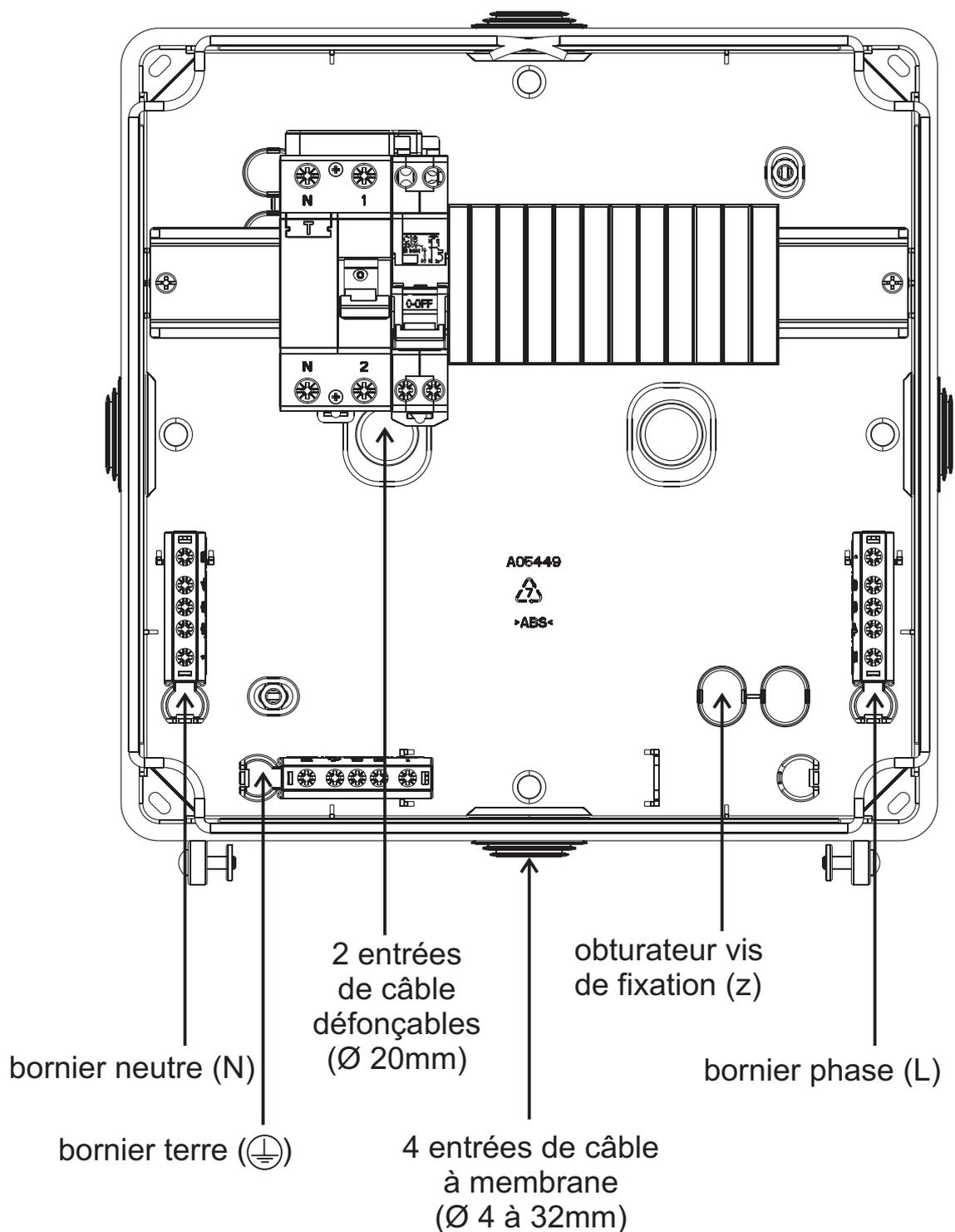
Utiliser l'une des entrées de câble du coffret pour introduire le câble de votre installation dans le coffret.
