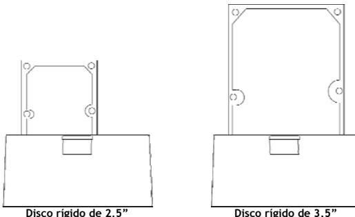
Depois do disco rígido ter sido inserido, pode ligar a estação de ancoragem através do interruptor situado na parte de trás.
