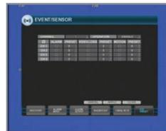
**CHANNEL:** N° du canal Vidéo sur lequel est raccordé le dôme motorisé.
