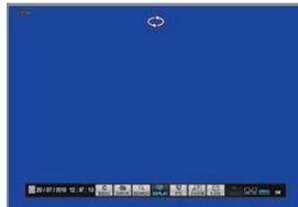
Chaque canal est montré en plein écran pendant une période déterminée (par défaut 3 secondes) avant de passer au canal suivant. Pour sélectionner le mode switcher, presser **AFF** de la barre de taches puis le symbole du **SWITCHER** qui se trouve en bas de la fenêtre le signal apparaît dans l'écran
