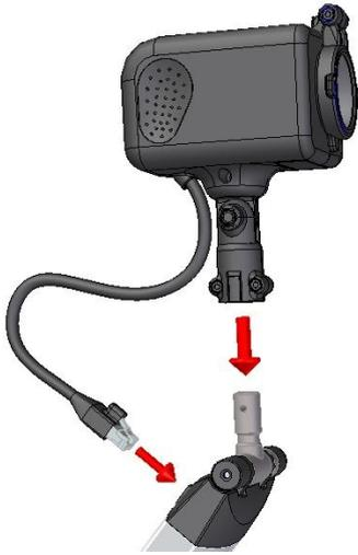
La caméra doit être enfoncée dans le piquot à l'extrémité du bras. Insérez la prise RJ45 de la caméra en haut du bras comme indiqué sur le schéma à gauche.
