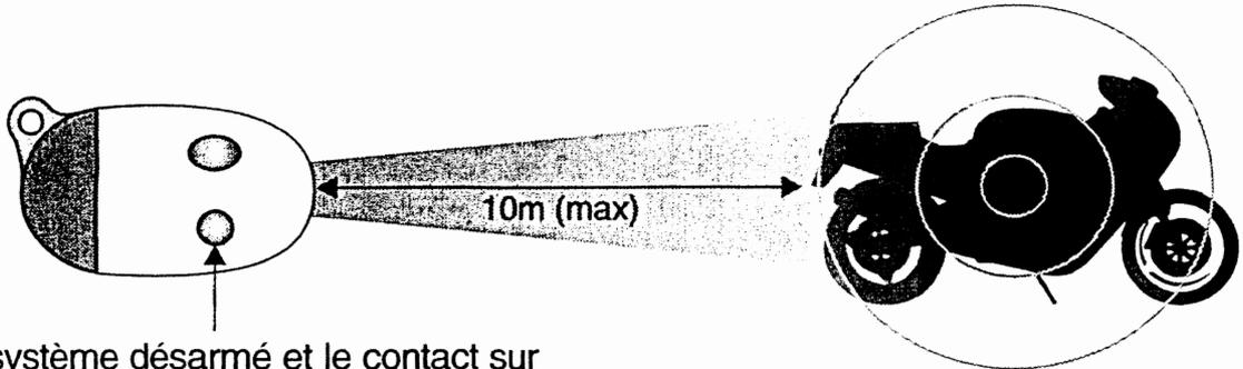
Avec le système désarmé et le contact sur "ON", maintenir appuyé le bouton jusqu'à l'émission d'un beep. Le contact peut être ensuite coupé.
