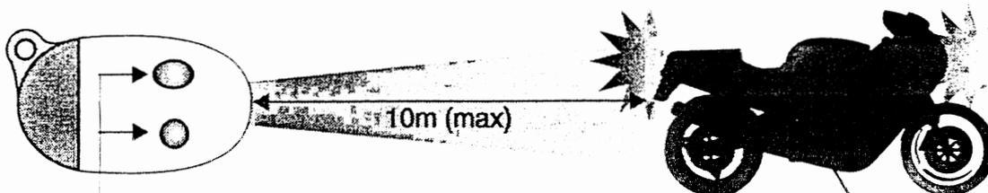
Avec le contact sur OFF, presser sur les 2 boutons durant 3 secondes
