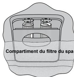
Lors de l'utilisation du spa ou d'un cycle de filtrage automatique, l'eau circule par le biais de l'écumoire du spa dans les deux cartouches de filtre à maillage polyester pour piéger les particules et les huiles en suspension sur les plis superficiels. Pour assurer une performance optimale, il est nécessaire de retirer et de nettoyer les cartouches de filtre une fois par mois selon votre utilisation du spa et la qualité de l'eau.
