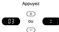
1. Si l'écran DEL affiche « U », appuyez sur le bouton Pompe à jet 1 pour basculer du système d'assainissement de « U » à « O3 » et pour quitter le menu de programmation. Si l'écran DEL affiche « O3 », appuyez sur le bouton Pompe à jet 1 pour basculer du système d'assainissement de « O3 » à « U » et pour quitter le menu de programmation.
