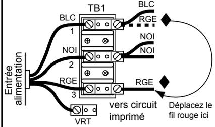
Modèles convertibles Denali/Tacoma Nord-Américains : 240V c.a., connexion à quatre fils (60 Hz)
