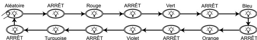
Il est indispensable d'appuyer sur le bouton LIGHT (ÉCLAIRAGE) dans les cinq secondes entre deux sélections « arrêt » ou « couleur » pour éviter sa réinitialisation. Si vous attendez plus de cinq secondes pour appuyer, l'éclairage s'allumera en mode « aléatoire ». Ce mode modifie automatiquement la couleur de l'éclairage toutes les 8 à 20 secondes.
