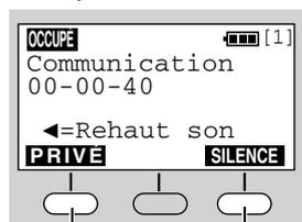
Trois touches sont utilisées pour la sélection des fonctions affichées directement au-dessus de chacune d'entre elles. Les fonctions affichées changent selon le mode d'opération de l'appareil.
