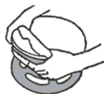
Figure G: Retirer soigneusement le bonnet de la polisseuse pour nettoyage.
