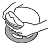
Rys. G : Zdjąć ostrożnie krążek do polerowania w celu jego oczyszczenia.
