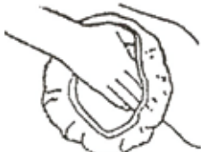
Рисунок F: Для оптимального качества полировки обрабатывайте труднодоступные места вручную.
