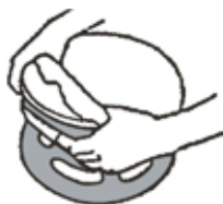
Figura G: Retirar suavemente a cobertura têxtil da polidora aquando a sua limpeza.
