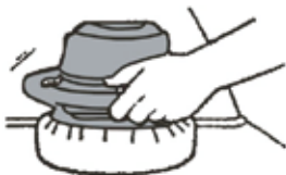
Figure C: Toujours allumer et éteindre la polisseuse lorsqu'elle est encore place sur la carrosserie.
