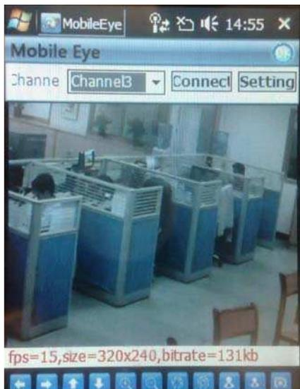
Les données affichées fournissent des informations sur la fréquence d'images (i/s), la résolution (taille) et le débit (Kbits/s) du canal sélectionné.
