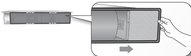
2. Nettoyer le filtre à air à l'aide d'un aspirateur ou d'un pinceau doux. S'il y a trop de poussière, le passer sous l'eau et le faire sécher dans un endroit aéré.
