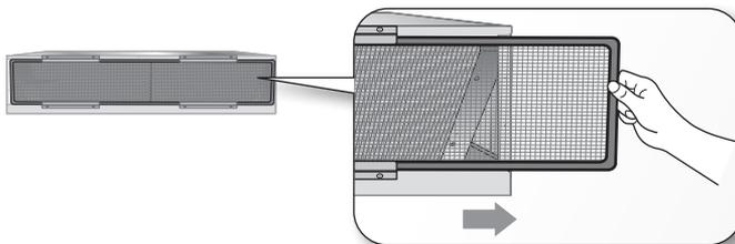
2. Nettoyer le filtre à air à l'aide d'un aspirateur ou d'un pinceau doux. S'il y a trop de poussière, le passer sous l'eau et le faire sécher dans un endroit aéré.
