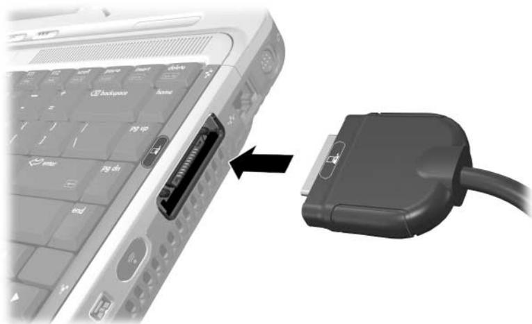
*Connexion du câble d'extension au portable*
