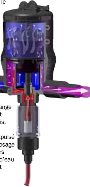
directement depuis son contenant. Dans la Chambre de mélange brevetée, le concentré est alors mélangé à l'eau, puis, le mélange parfaitement homogénéisé est alors expulsé en sortie de pompe. Le dosage du concentré sera toujours proportionnel au volume d'eau entrant dans la pompe, et ce quelles que soient les variations de débit ou de pression.
