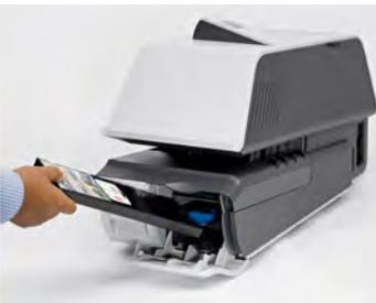
4. Insérez le nouveau réservoir d'encre en exerçant une pression jusqu'au déclic.
