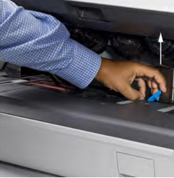
3. Poussez la rampe de mouillage vers l'arrière pour la détacher.
