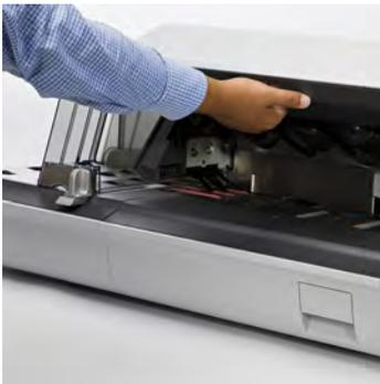
2. Tirez vers le haut la partie droite du levier de dégagement bleu pour déverrouiller la rampe de mouillage.
