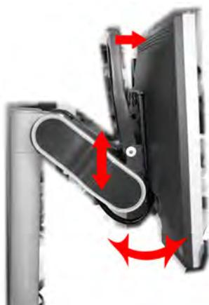
Utilisez la poignée située derrière l'écran (flèche du haut sur l'illustration ci-dessus) pour déverrouiller le mécanisme et régler la hauteur et l'angle.
