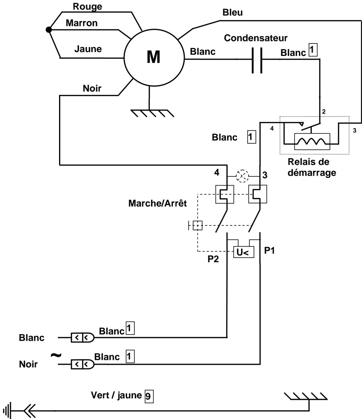
Schéma électrique 110-120V 50/60Hz Modèle n°4
