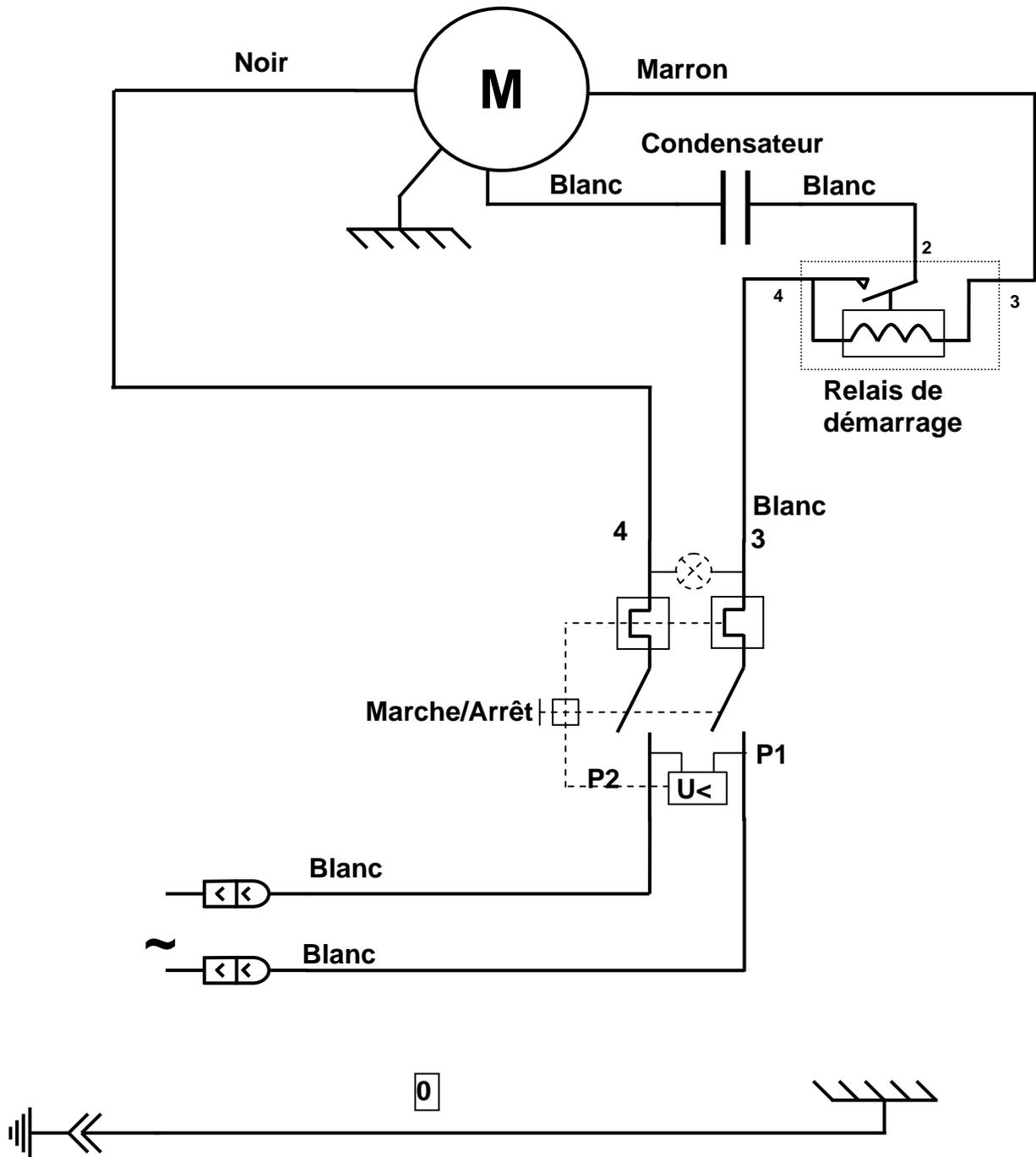
Schéma électrique 220-240V 60Hz Modèle n°1
