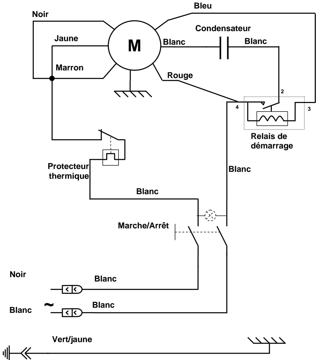
Schéma électrique 220-240V 50Hz Modèle n°4
