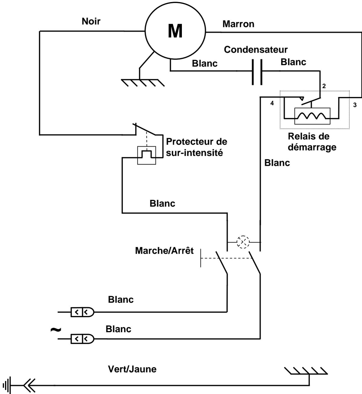
Schéma électrique 220-240V 60Hz Modèle n°4
