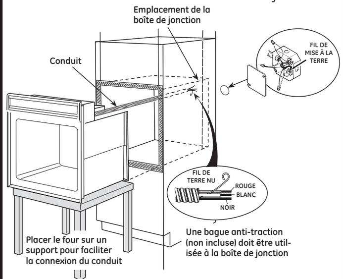
**B3** Ce four est doté d'un conduit flexible de 123 cm (48 po) comportant :
