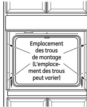
Les vis doivent être à une distance d'au moins 6 mm (1/4 po) du devant de l'ouverture.
