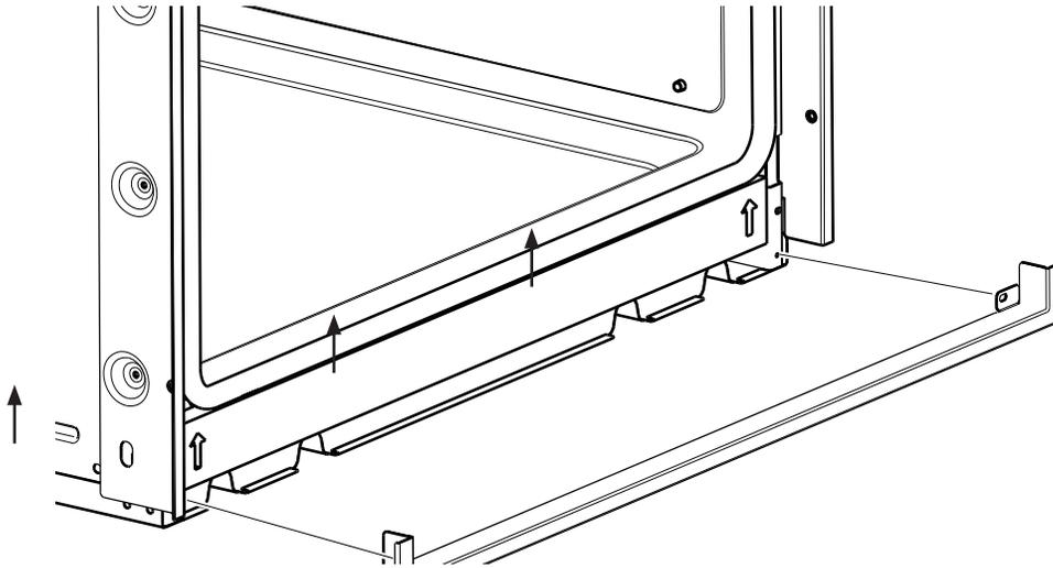
**IMPORTANT :** La garniture risque d'être endommagée si elle n'est pas enlevée en premier lorsque l'appareil est retiré de l'enceinte pour une réparation ou une autre raison.
