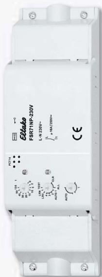
**Télérupteur/relais de commutation avec 1 contact NO 16A/250V AC non libre de potentiel, lampes à incandescence 2000 W. Avec scénarios de lumières via PC ou via les poussoirs radio. Le cryptage, la communication radio bidirectionnelle et la fonction répétiteur peuvent être enclenchés. Perte en attente seulement 0,8 Watt.**
