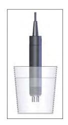
4) Plonger la sonde pH dans la solution pH7 pendant 2 minutes.
