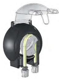
Pour enlever le tuyau, soulever le couvercle. Tirez sur le raccordement gauche pour le libérer de son logement. Faite tourner le porte galet en manuel ou en automatique en utilisant le mode «TEST» jusqu'a dégager le tuyau complètement puis tirer sur le raccord de droite.
