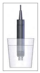
7) Plonger la sonde pH dans la solution pH10 pendant 2 minutes.
