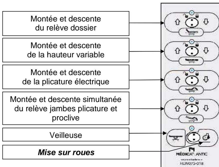
Quand le lit est sur ses roues (**ayant une fonction ménage et non de brancardage**), un bip sonore vous prévient pour ne pas oublier d'appuyer sur la touche montée afin de l'immobiliser pour qu'il prenne appui sur ses 4 patins.
