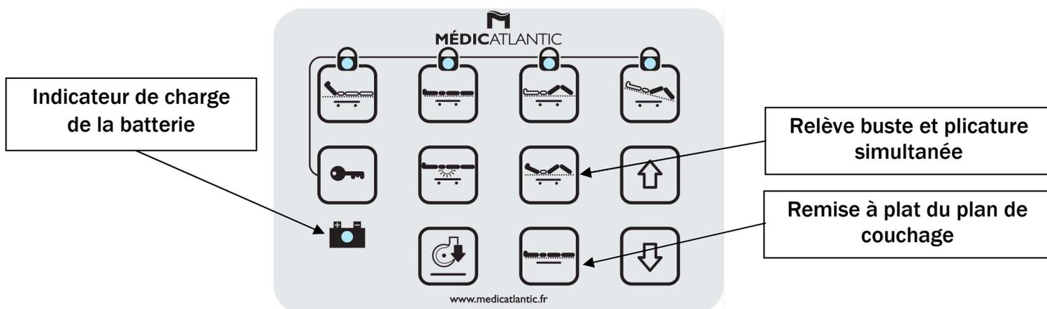
Pour verrouiller les fonctions (relève dos, hauteur variable, relève jambes, proclive), appuyer simultanément sur la touche "clef" et la fonction à verrouiller.
