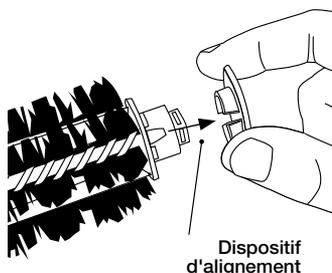
E. Utilisez l'outil de nettoyage compris pour aisément supprimer les poils des brosses du Roomba en les tirant et en les faisant passer au-dessus des brosses.
