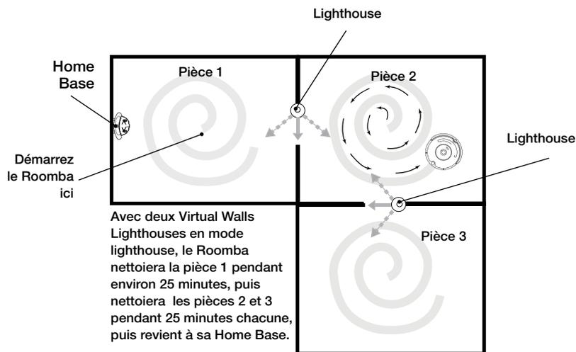
**CONSEIL :** lorsque le Roomba est en mode Lighthouse, ne pas le déplacer manuellement d'une pièce à l'autre pendant le nettoyage.
