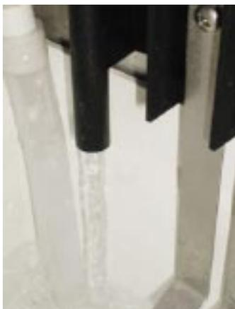
3. L'eau commence à remplir le réservoir d'eau jusqu'au le niveau maximal contrôlé par une sonde niveau d'eau.
