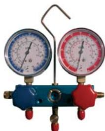
MANIFOLD livré en mallette de transport avec 3 flexibles 1/4" - 5/16" pour R410A de 90 cm avec joints Téflon et 2 bonnettes de protection
