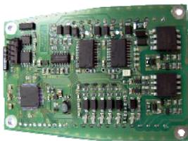
**Carte circuit imprimé (PCB):** Conçue au moyen des dernières technologies les composants électroniques ont été soumis à une protection totale par tropicalisation. Les sorties sont protégées contre les erreurs de raccordement. Un fusible réarmable est utilisé contre les surtensions/inversions de polarité.
