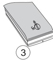
Avant d'insérer le module de batterie dans le téléphone, s'assurer que le verrou est en position déverrouillé.
