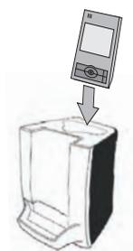
Un emplacement à l'arrière du chargeur est réservé pour charger une batterie supplémentaire :
