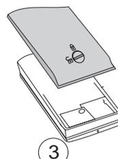
Mettre le verrou sur la position déverrouillé.
