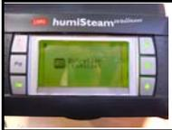
Le masque utilisateur apparaît. Faire défiler à l'aide des flèches jusqu'à 'entretien' puis appuyer sur 'ENTREER' et descendre avec les flèches jusqu'au menu 'entretien logiciel' Appuyer sur 'ENTREER'
