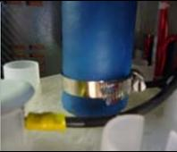
Le tube bleu de vapeur doit être placé sur le dessus du cylindre. Pour ce faire casser l'opercule en plastique qui empêche le passage du tube et raccorder ce même tube au cylindre, avec un collier de serrage en acier pour le maintenir.
