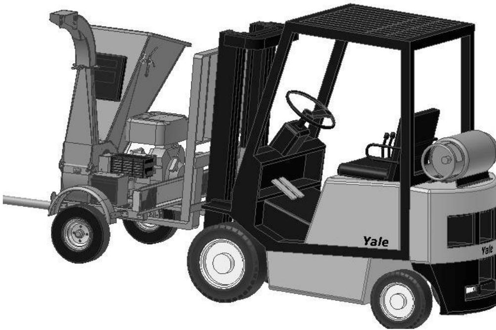
**Figure 4 Levage à l'aide d'un chariot-élévateur à fourche, PDF.**
