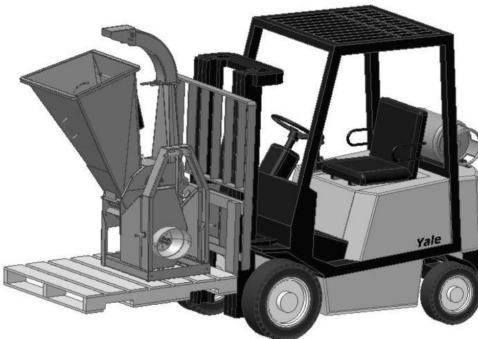
**Figure 3** Levage à l'aide d'un chariot-élévateur à fourche, PDF.
