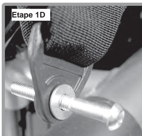
Faire passer le boulon en travers du châssis du fauteuil. Mettre en place l'autre rondelle à l'extrémité du boulon et contre le châssis. Installer la rondelle et l'écrou.
