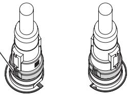
Mécanisme de verrouillage rotatif du connecteur
