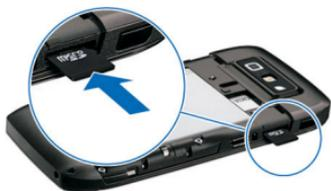
2. Insérez la carte mémoire dans le logement, les contacts de la carte étant orientés vers l'avant. Assurez-vous que les contacts sont face aux connecteurs de l'appareil.
