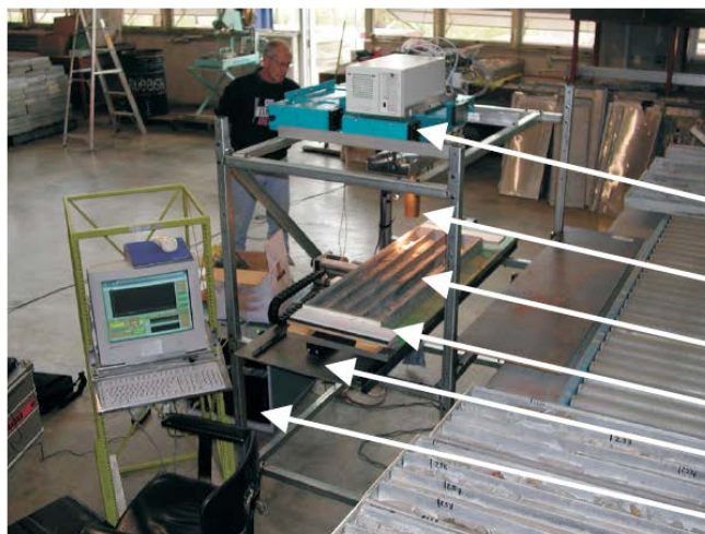
Figure 9. Une vue d'une version plus ancienne du prototype HyLogger de CSIRO (source : Jon Huntington, commun. pers., 2006)
