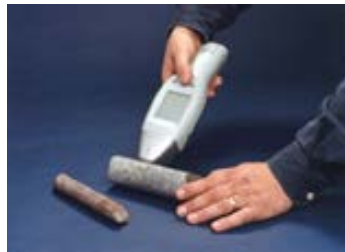
Figure 10. Analyseur XRF portable Niton.
