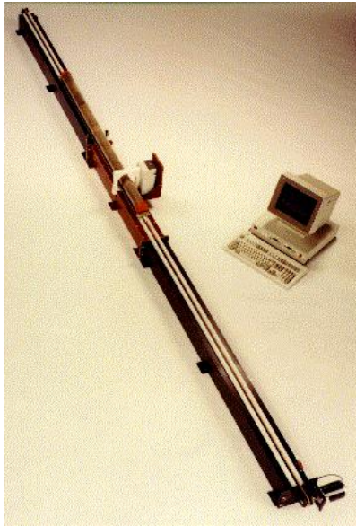
Figure 3. Le système automatique de la compagnie ASC pour les mesures de susceptibilité magnétique sur carottes de forage.
