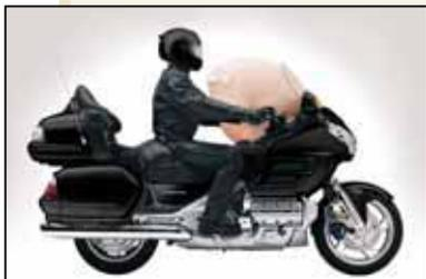
>>> La Gold Wing Airbag incorpore un système simple et compact de coussin gonflable qui peut aider à réduire la sévérité des blessures en cas d'impact frontal. Quatre capteurs installés sur la fourche mesurent la variation de décélération causée par un impact et envoient ces données à un ECU qui
