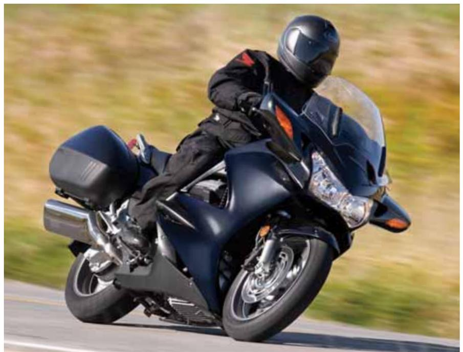
de couple capable de se jouer d'une route de montagne en lacet ou d'une autoroute des prairies. Les deux d'arbres d'équilibrage du moteur contribuent à éliminer les dures vibrations. Le cadre aluminium à double longeron est construit solide, mais léger également, pour un comportement agile sur votre route sinueuse favorite. Et le Double système de freinage Combiné avec ABS (système antiblocage) de la ST1300A vous permet d'explorer avec plus de confiance.
