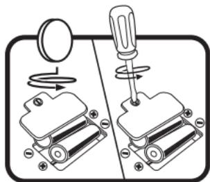
3. Insérer 2 piles LR03/AAA en respectant le schéma qui se trouve dans le compartiment à piles.
