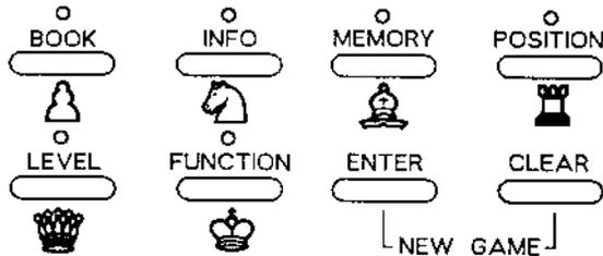
Il suffit de 8 touches pour vous permettre de procéder à tous les réglages nécessaires et d'accéder à une multitude d'informations disponibles. A cette fin, l'appareil est muni d'un affichage à 4 positions, de 6 voyants lumineux de fonction placés au-dessus des touches ainsi que de 2 jeux de 8 diodes électroluminescentes (appelées LED) chacun, disposés sur les bords inférieur et gauche de l'échiquier et permettant d'indiquer les coordonnées des cases.
