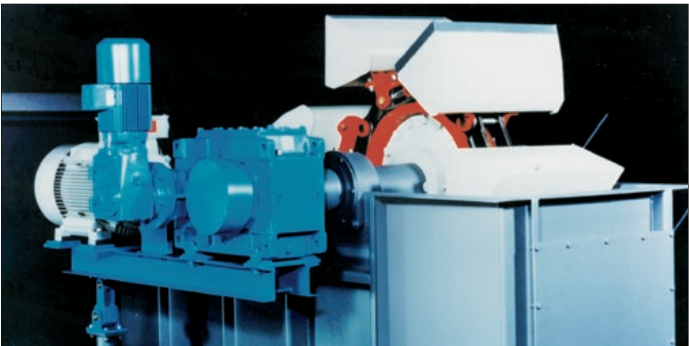
FLENDER-Zahnradgetriebe im Antrieb eines Becherwerks in der Zementindustrie
